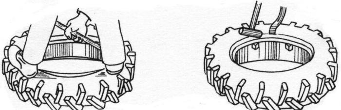
Рис. 3.21. Монтаж шины
