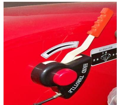
Рис. 3.16. Ручной акселератор
