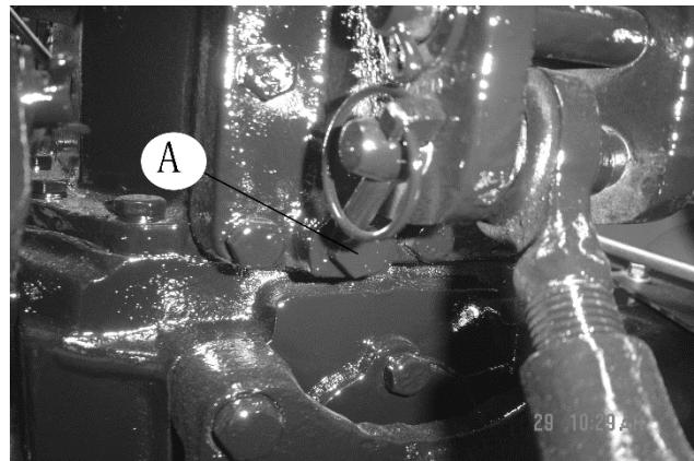
Рис.5-30 пробка смазки
