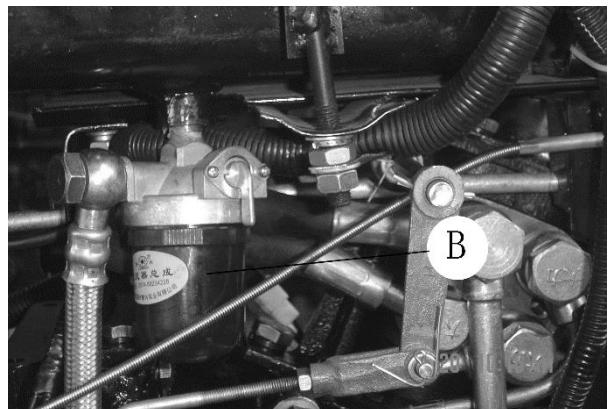
Рис.5-32 Отстойник топливного бака
