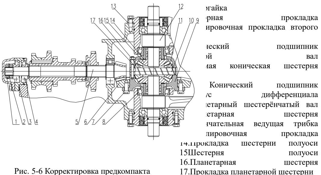
Рис. 5-6 Корректировка предкомпакта конического подшипника
