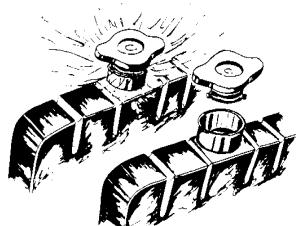
Рис. 1-14. Откручивание крышки радиатора
