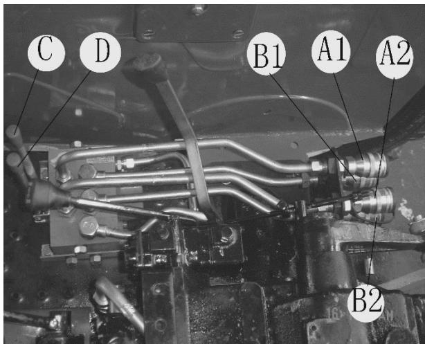
Рис. 3.25. Многоканальный клапан
