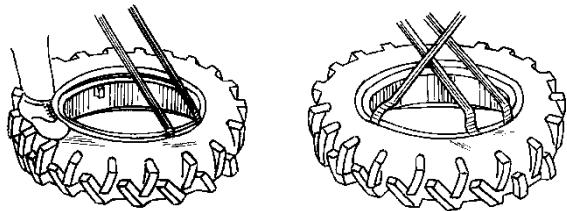
Рис. 3.20. Демонтаж шины
