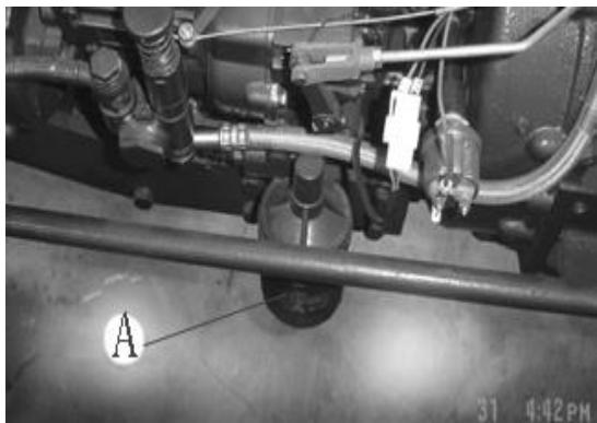
Рис.5-25 Уход и содержание фильтра машинного масла
