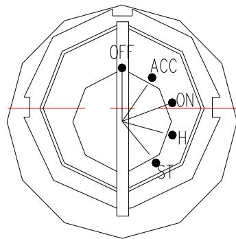
Рис. 3.15. Замок зажигания
