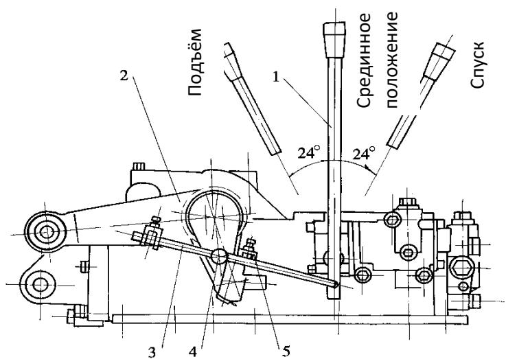
Рис.5-18 корректировка спускового места
