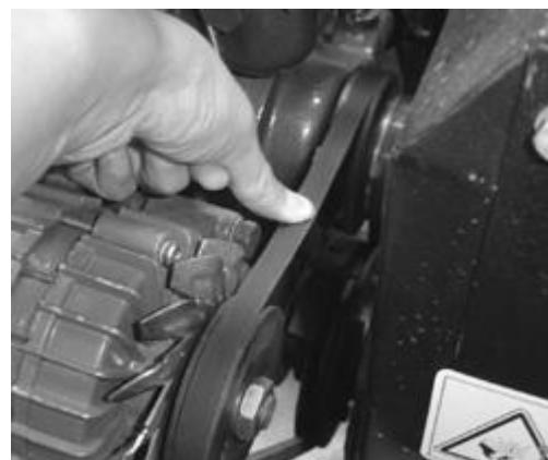
**Рис. 5-21 Регулирование натяжения резиновой ленты вентилятора**
