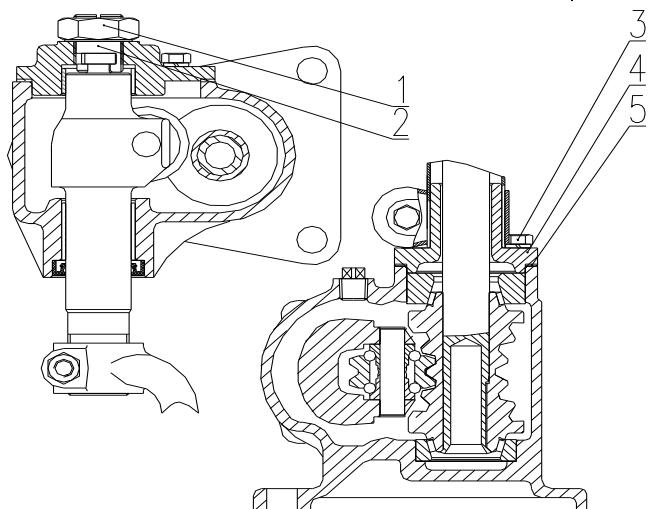
Рис.5-8 корректировка картера рулевого управления
