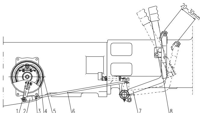
Рис.5-4 тормозная система
