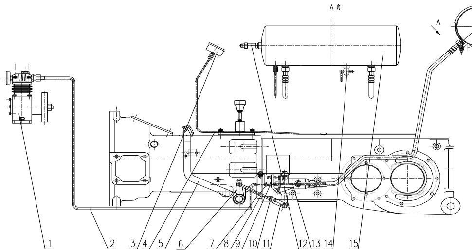
Рис. 5-5 пневмотормозная система трайлера
