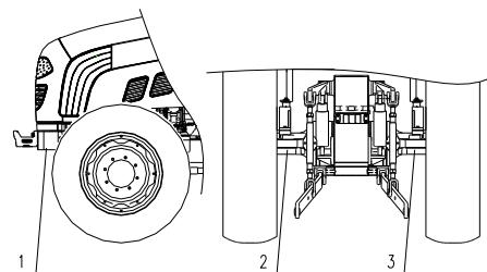
Рис. 1-7. Точки поддомкрачивания
