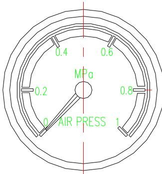
Рис. 3-7. Манометр
