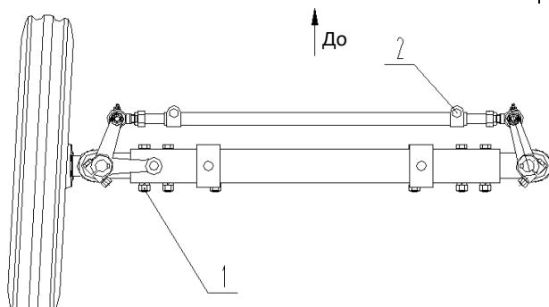
Рис.5-12 корректировка базы переднего колеса
