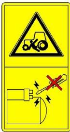
Смыслоное значение: при запуске двигателя водитель должен сидеть на водительском сидении, нельзя запустить двигатель методом короткого замыкания контактов стартера, чтобы избежать телесных повреждений.
