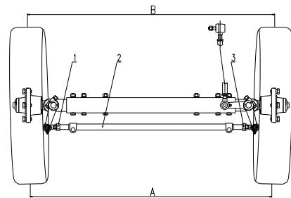
Рис. 5-11 Корректировка переднего пучка переднего колеса
