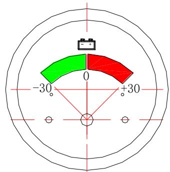
Рис. 3.6. Амперметр
