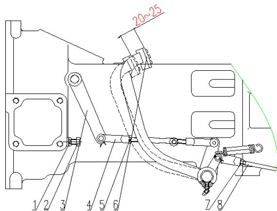
Рис. 5-2 схема управления сцепления
